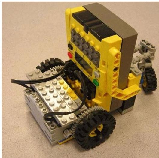
Figure 7-4 : Le robot de LEGO Mindstorm [Allevard 05]
