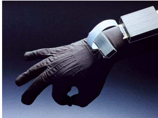
Fig. 18 Le 5DT DataGlove 16-W, 14 capteurs, version sans fil (Tiré de [www.5dt.com]).
