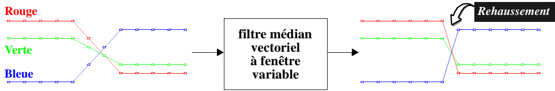
Fig. 28 : Effet de rehaussement du filtre médian vectoriel à fenêtre variable (taille 5)
